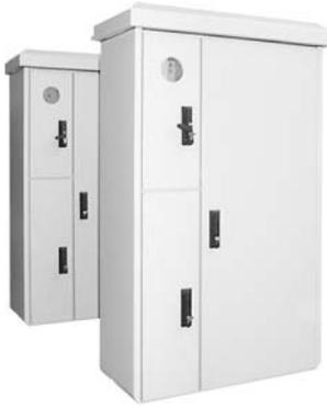
Шкафы с двойными стенками и принудительной вентиляцией, заключающейся в прохождении воздуха между стенками, без подачи его внутрь шкафа, а также с обогревом, обеспечивающим идеальные условия работы установленных внутри устройств. Изготовлены из алюминиевых листов, окрашенных порошковыми красками. Оснащены системой питания и измерения энергии в
