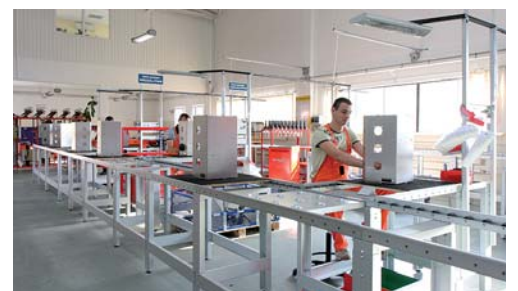
Линия монтажа выключателей нагрузки с элегазовой изоляцией SF 6
